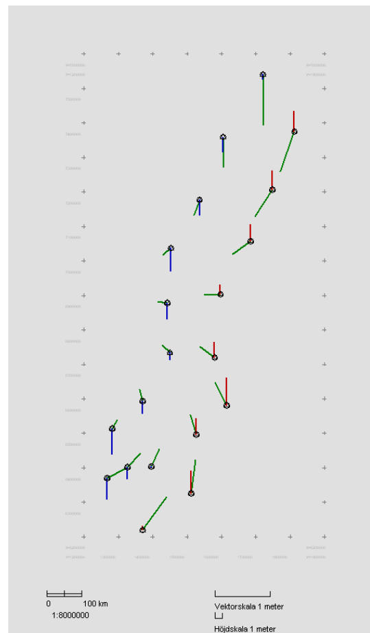
Figur 5: Passfel vid inpassning med 3 translationer samt rotation runt de topocentriska z- och y-axlarna. Gröna vektorer för horisontella och röda/blå för vertikala passfel.
